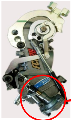
Gambar 22: Karburator FCR dengan pompa akselerasi
