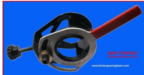
Gambar 30: STOPPER untuk membatasi bukaan gas pada Posisi % TPS yang diperlukan.
