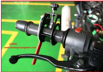
Gambar 29: Pemasangan STOPPER Grip Gas
